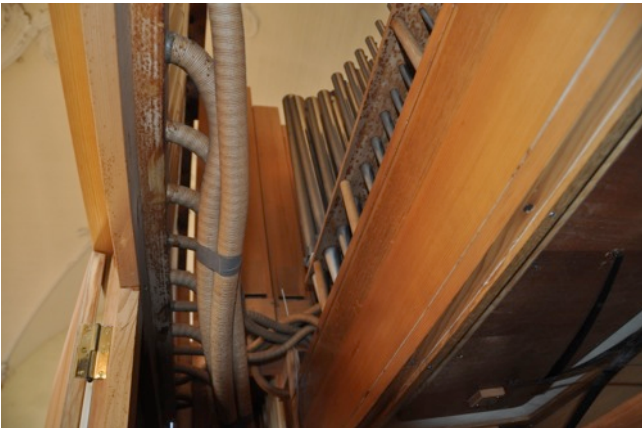
Windversorgung ab den Windladen zu den Orgelpfeifen im Prospekt
