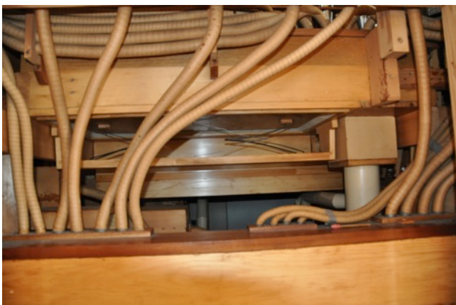
Ein Wirrwarr von Rohren führen den Wind von den Windladen und Tonventilen zu den Orgelpfeifen.
