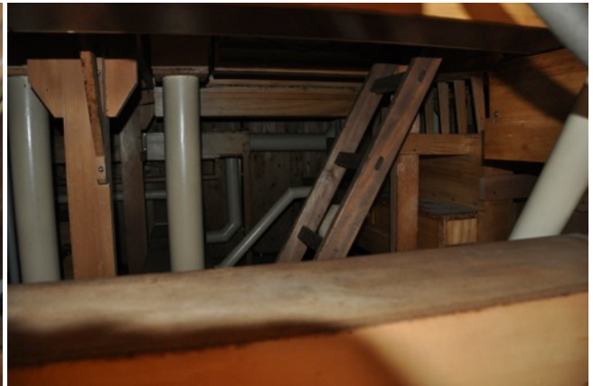
Im Herz der Orgel – die dicken Rohre stellen die Windversorgung sicher
