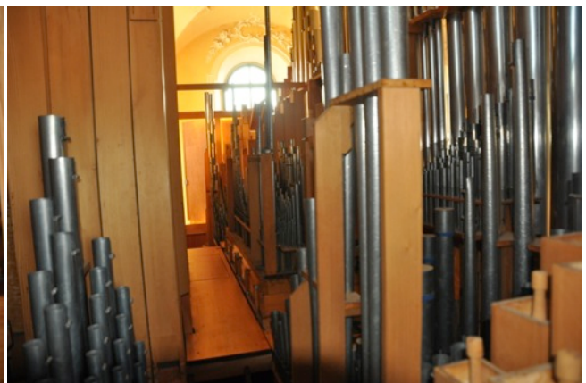
Pfeifen aus Metall und Holz, gekröpft und ungekröpft, als Labial- oder Lingualpfeifen
