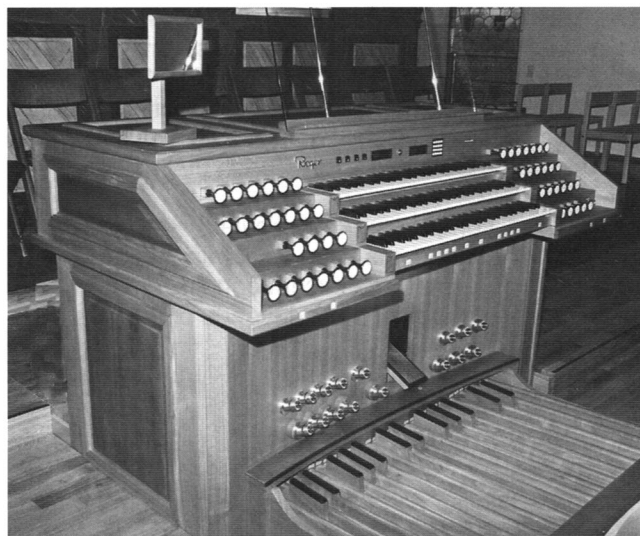
La console entièrement mécanique, avec combinateur (Photo François Comment)
