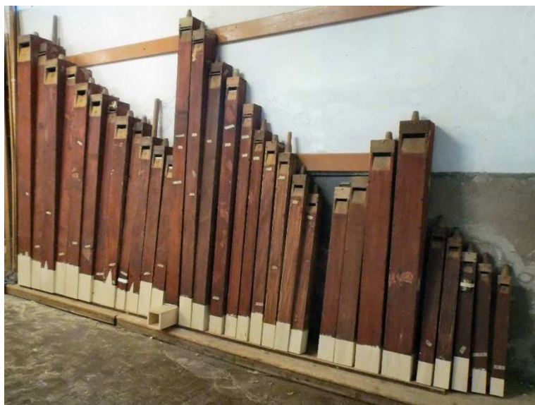
Canne di legno restaurate e allungate, pronte per essere ritinteggiate
