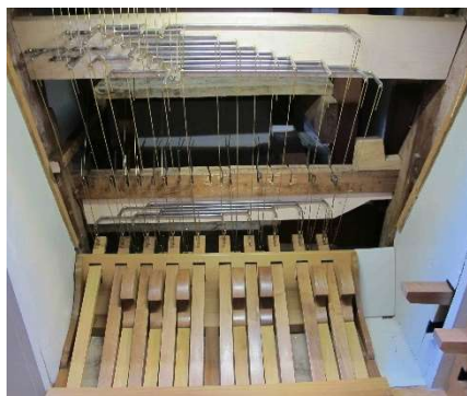
Catenacciatura del pedale prima del restauro (sx) Pedale e catenacciatura ricostruiti (dx)
