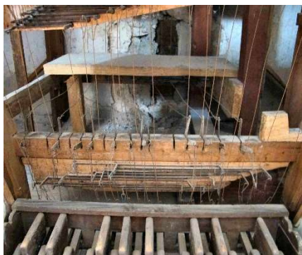
Catenacciatura del pedale prima del restauro (sx) Pedale e catenacciatura ricostruiti (dx)
