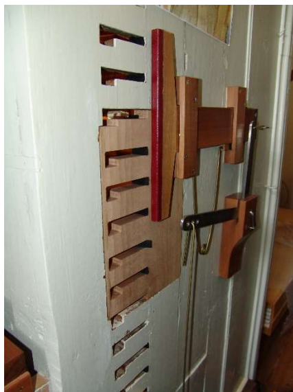
La registrazione originaria era nascosta da un pannello (sx) La ricostruzione della registrazione con il comando del tiraripieno (dx)
