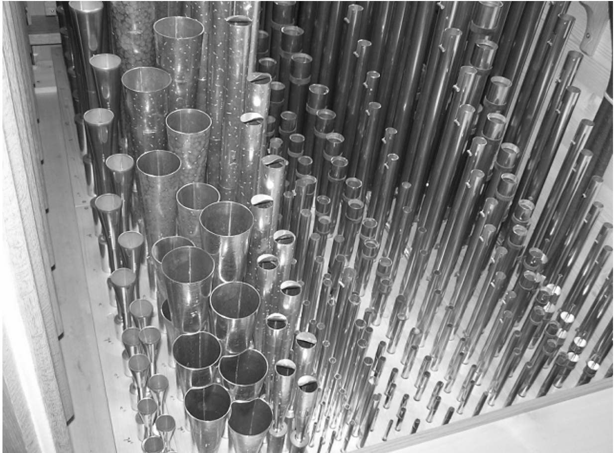
Die neue Orgel: Blick in die linke Hälfte (C-Seite) des Schwellwerks von der Mitte aus. Links im Bild (= vorne) das Register Oboe 8' (enge Schallbecher mit trichterförmigem Aufsatz), rechts davon Trompette harmonique 8' (typisch die relativ langen Schallbecher), dann Dulcian 16' und anschliessend die Labialregister des Schwellwerks. Foto: F.L.
