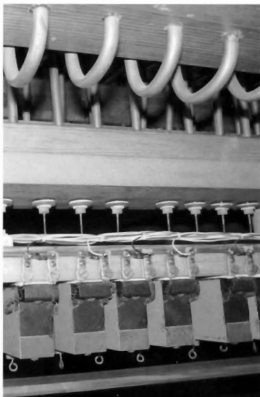
Les électro-aimants de 1928 activent les soupapes pneumatiques. Le câblage est récent. (Photo François Comment)
