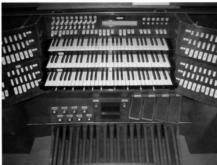
Un rouleau de Crescendo, quatre bascules, mais pas de pistons pour les combinaisons! (Photo François Comment)
