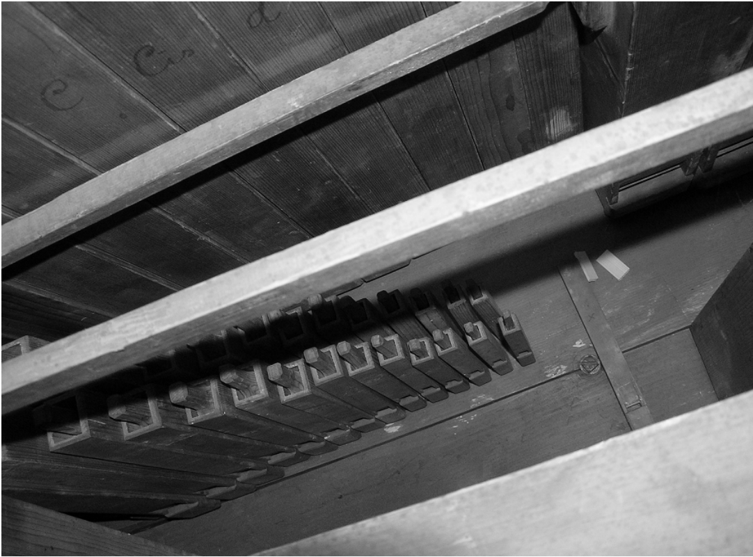
OBEN: Hausorgel Wintersberg: Pfeifenanordnung. Sicht vom Prospekt aus: Copel 8'. Chromatische Pfeifenanordnung entsprechend der Tastatur. Die unterste Oktave an der Rückwand, die tiefsten platzverbrauchenden Pfeifen eher rechts, da sie ohnehin nicht direkt durch Stechermechanik, sondern über ein kleines Wellenbrett angesteuert werden.
