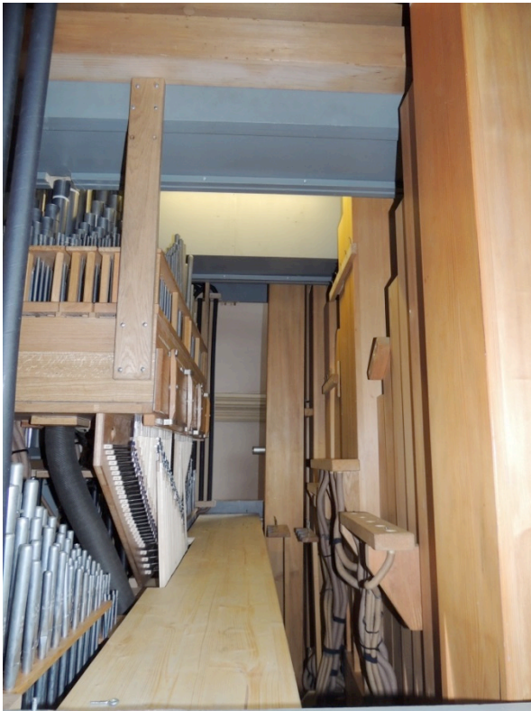
Die Holzpipen, welche den Zugang zum Pfeifenwerk versperrten wurden ins Dach verlegt und mit Kondukten an die Windversorgung angeschlossen.
