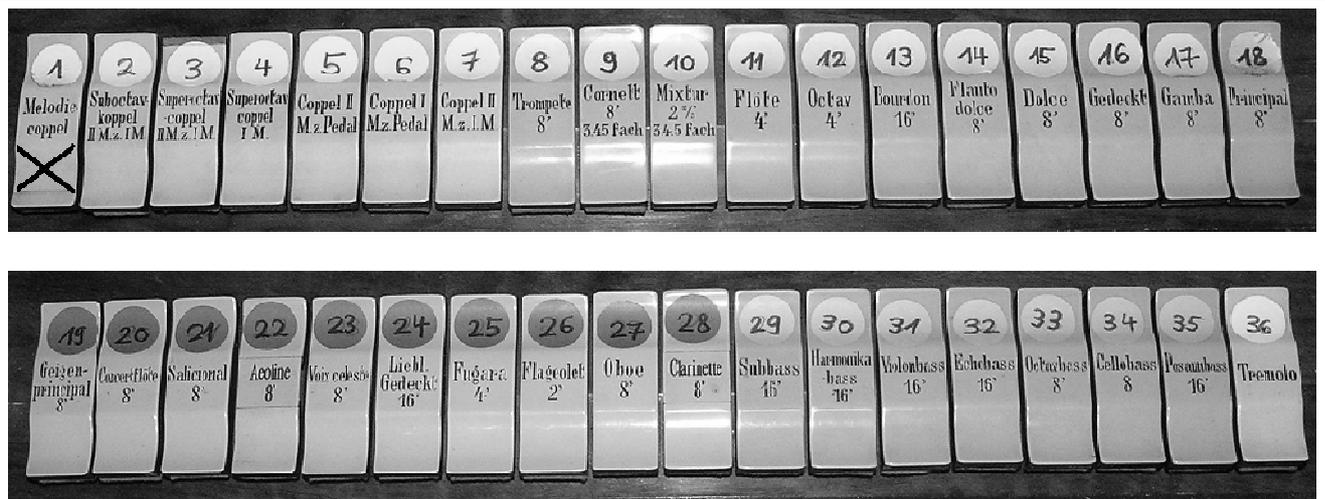
Abb. 6: Anordnung der Registerklappen über der Tastatur in etwas ungewohnter Reihenfolge. Untere Reihe (II. Man. und Pedal) auf der rechten Seite, obere Reihe (Koppeln und I. Manual) auf der linken Seite (Melodiekoppel heute funktionslos).
