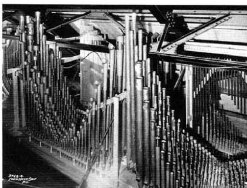
«Echo Chamber» de l'orgue du Convention Hall d'Atlantic City. A droite on reconnaît les résonateurs suspendus d'un Carillon. (Photo X)
