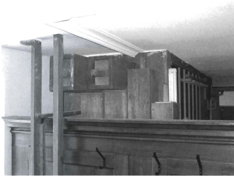
«Nous n'avons pas un centimètre à perdre»: la boîte expressive enfoncée dans le plafond. les tuyaux en partie coudés de la Soubasse et la barre traversant le plafond qui permet d'actionner la soufflerie à l'aide d'une pédale. (Photo François Comment)
