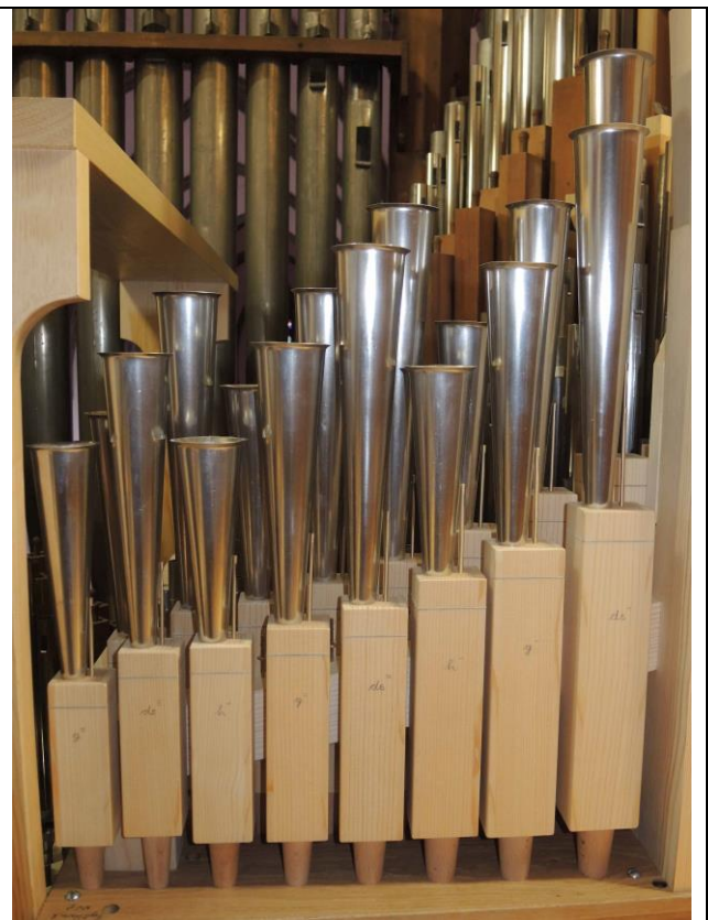
Clarinette 8', Rekonstruktion nach zeitgleichen Originalen von Steinmeyer
