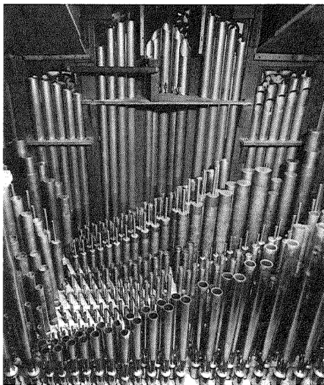
Blick ins Rückpositiv-Gehäuse: Prospekt Pfeifen (ausser den 5 klingenden Prestant 4'-Pfeifen rechts auf dem Bild sind alle andern hier sichtbaren stumm), anschliessend die kleineren Prestant 4'-Pfeifen auf der Lade, dann Flöte 4', Bourdon 8', Nazard 2 2/3', Doublette 2', Tierce 1 3/5', Larigot 1 1/3', Fourniture 3-fach und Cromhorne 8'.
